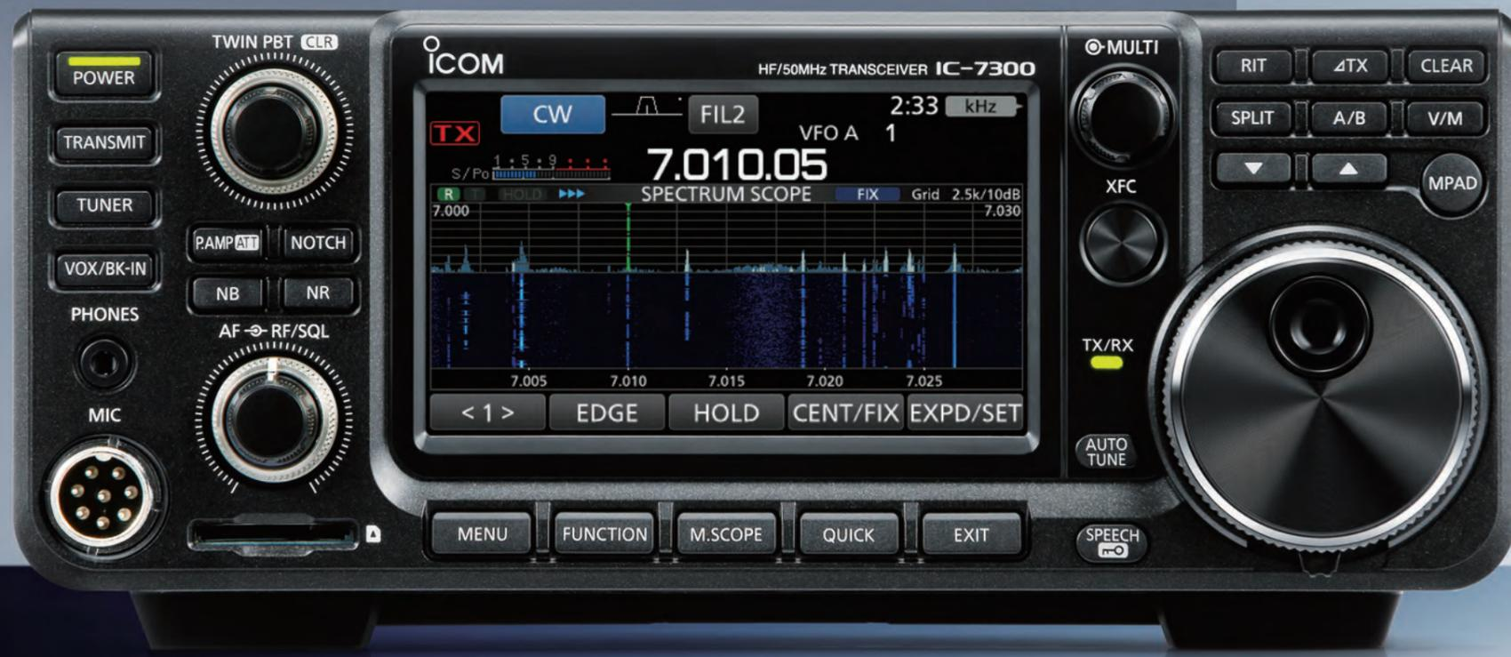
HF+50MHz(SSB/CW/RTTY/AM/FM)100Wトランシーバー
