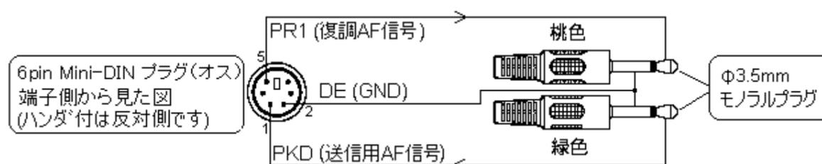
②「シリアル通信ケーブル」(PC 端子・通信用)の内部配線は以下の通りです。
