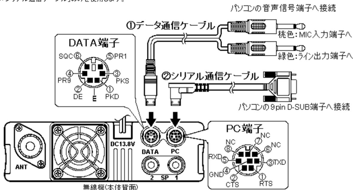
①「データ通信ケーブル」(DATA 端子・音声入出力用)の内部配線は以下の通りです。
