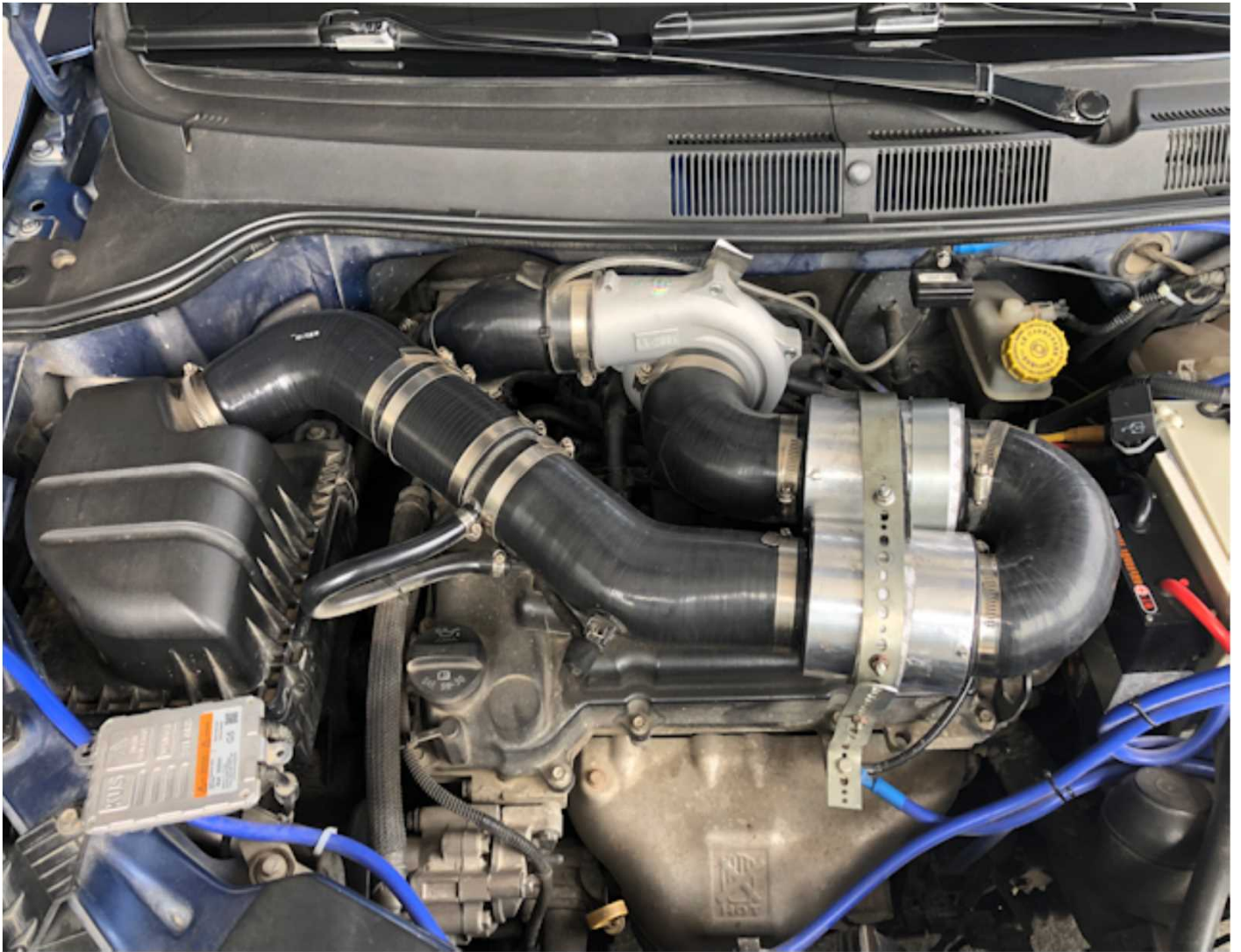
アース線の追加と消音器の帯電防止強化
