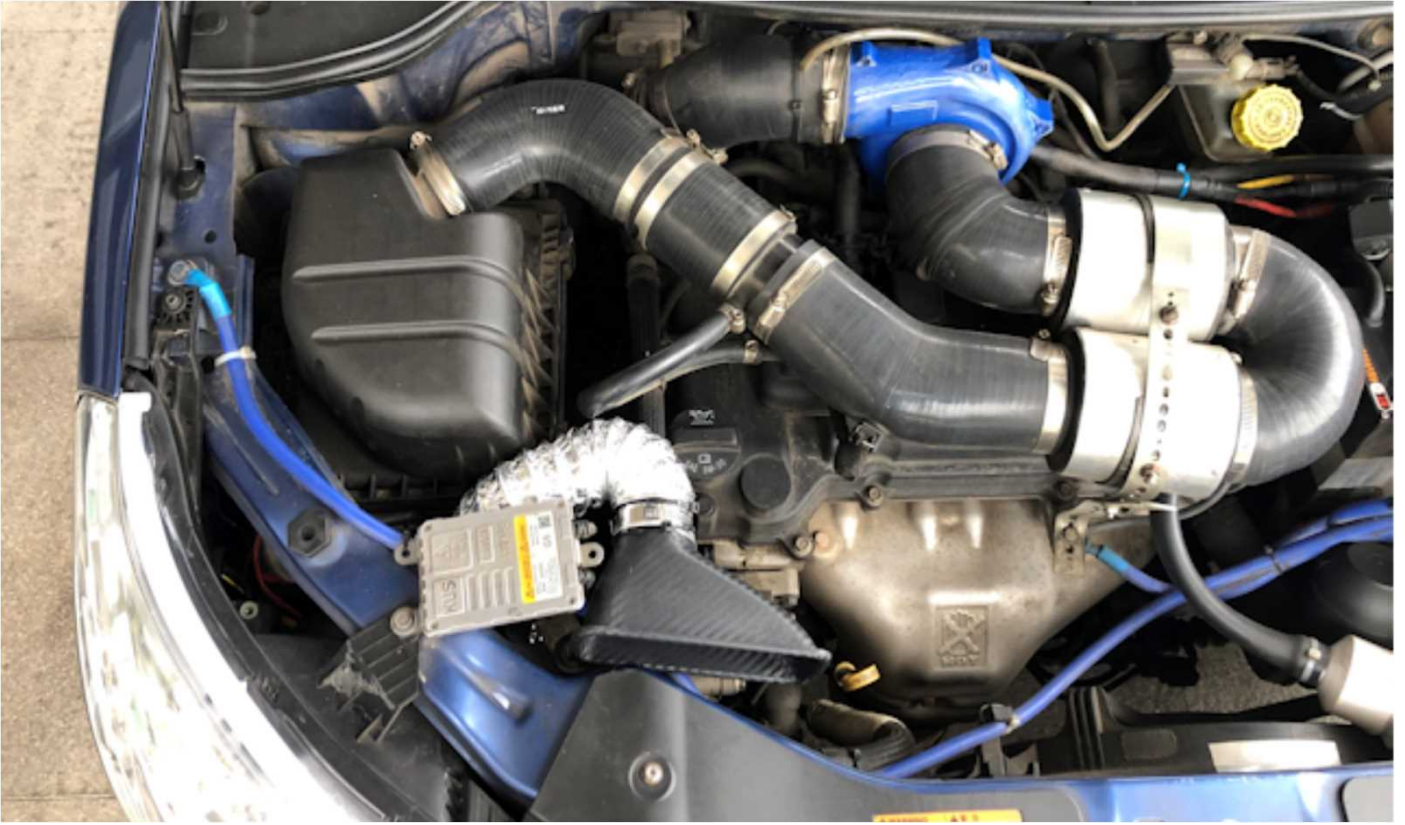
吸気配管の変更（エアークリーナーBOX下の消音器を変更）
