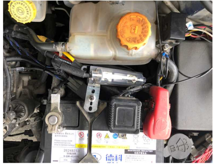
電子ターボ電源 (80A→100Aへ変更)
