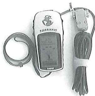
写真1 GARMIN POKE-NAVIとシリアルケーブル
